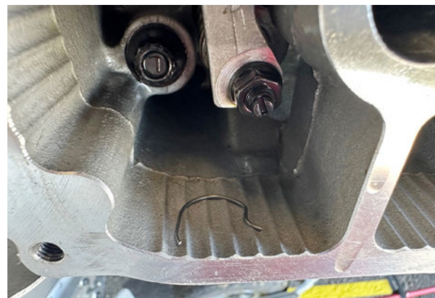
Gebrochene Feder eines Einlassventils, gefunden im Zylinderkopf Ressort cassé d'une soupape d'admission, trouvé dans la culasse
