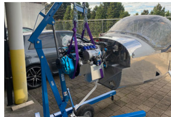
Das Triebwerk von AeroMomentum hängt am Kran, bereit zum Einbau Le moteur d'AeroMomentum suspendu à la grue, prêt à être installé
