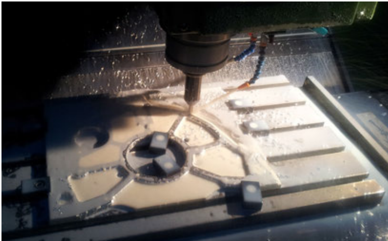
Fertigung Riemenscheibe auf konventioneller Fräsmaschine. Fabrication d'une poulie sur une fraiseuse conventionnelle.
