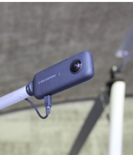
< 360° Kamera Insta360 One X, befestigt am Flügelausleger mit externer Stromversorgung Caméra 360° Insta360 One X, fixée sur la flèche de l'aile avec alimentation externe
