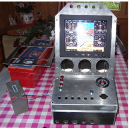
Erste Versuche unter Spannung. Avionik; Nesis III von Kanardia. Premiers essais sous tension. Avionique ; Nesis III de Kanardia.
