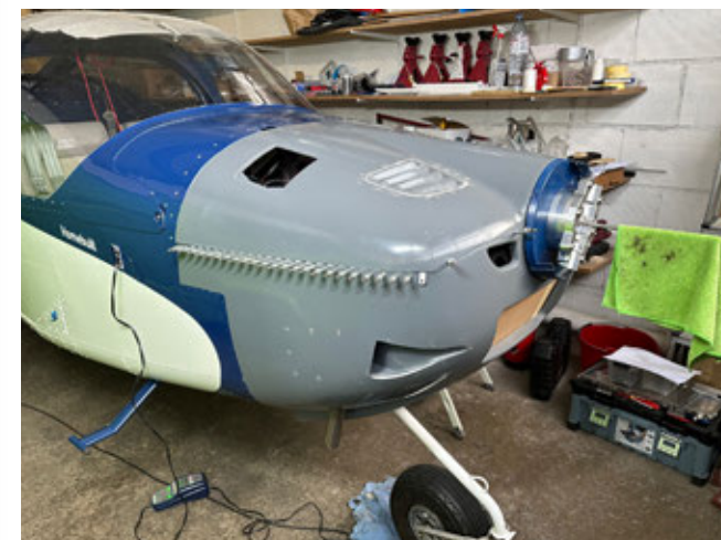
Auch die Cowling musste für den neuen Motor komplett ersetzt und angepasst werden
