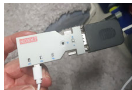
< IRXON Adapter mit Powerkabel (unten links), DB9 female Stecker (schwarz) und Kabel zum Funkgerät (rechts oben) Adaptateur IRXON avec câble d'alimentation (en bas à gauche), connecteur DB9 femelle (noir) et câble vers la radio (en haut à droite)
