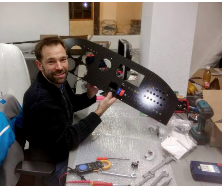
Frisch ausgefräst: Neues Panel aus CFK Fraîchement fraisé : Nouveau panneau en PRFC
