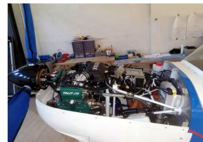
< Motoreinbau fertig gestellt Installation du moteur terminée
